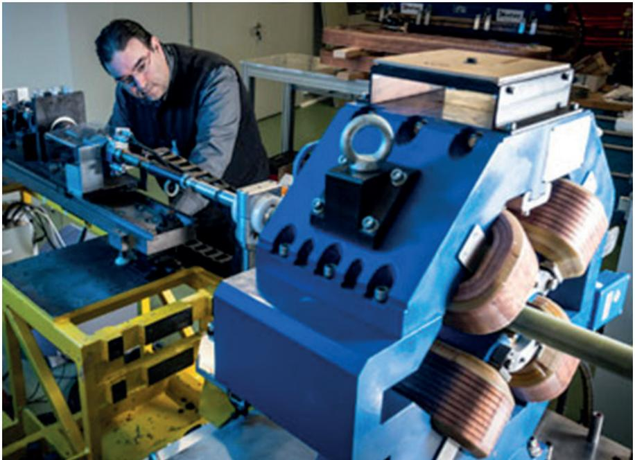
**Figura 3.** Ejemplo de imán cuadrupolar utilizado en ALBA para enfocar los electrones y transportarlos a través de largas distancias.
